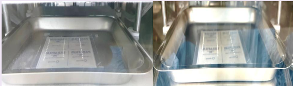
圖二、左圖為-50 度預凍小球(凍乾前)，右圖為破真空凍乾小球(凍乾後)
